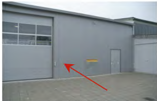
145-21 Streckenmelder 2 x 12 m im Außenbereich zur Überwachung von Tor und Außenwand, Montagehöhe 0,8 m
